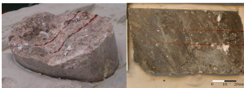
6. ábra: Érdes felületű gránit (baloldali kép) és sima felületű agyagos minta (jobboldal) nyírásvizsgálat előtt
