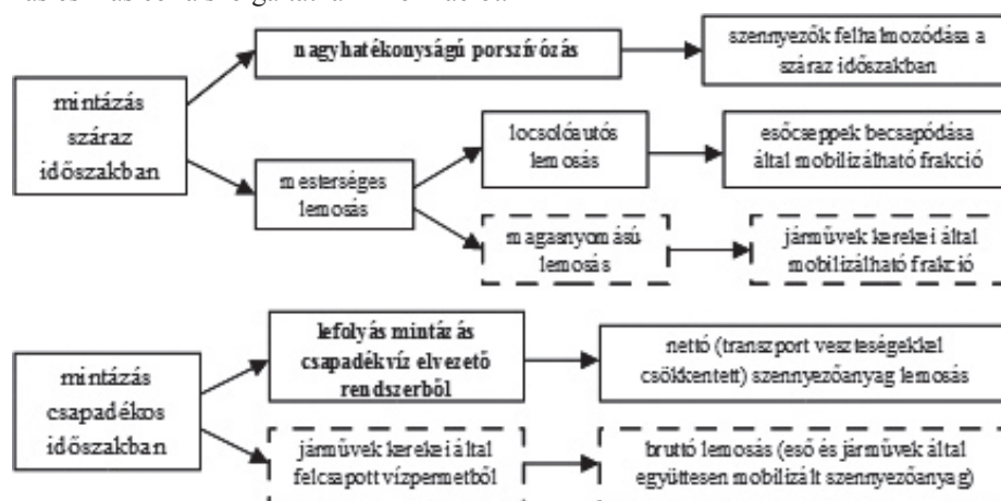
1. ábra: Útpályákról lefolyó vizek szennyeződésének vizsgálatára irányuló mintavételi módszerek és az általuk nyújtott információ (vastagon szedve a leggyakrabban alkalmazott, szaggatottan keretezve pedig a kutatás során alkalmazott újszerű módszerek)
