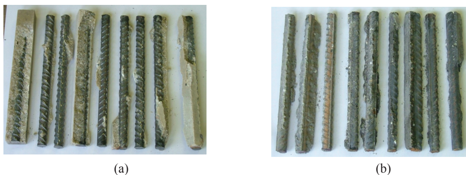
2. ábra: A polimerbeton (a) és cementbeton (b) próbatestekben elhelyezett betonacélok a korróziós kísérlet elvégzése után
