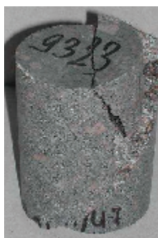
4. ábra: Egyirányú nyomószilárdság vizsgálat során tönkrement próbatest szabálytalan törésképe
