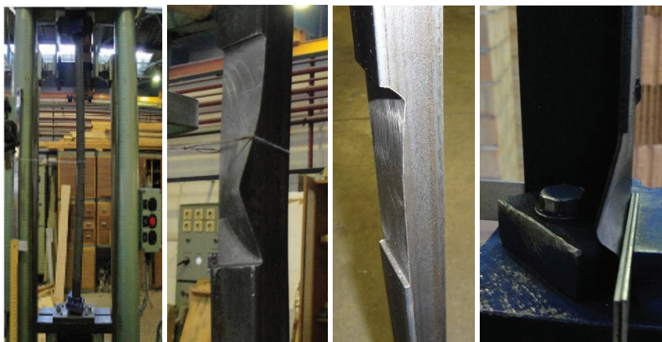
3. ábra: Tönkremeneteli alakok
