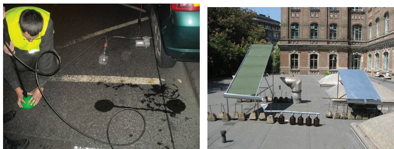
2. ábra: (a) Lemosásos mintavétel a Budafoki úton; (b) csapadékvíz mintavevők az U épület tetején
