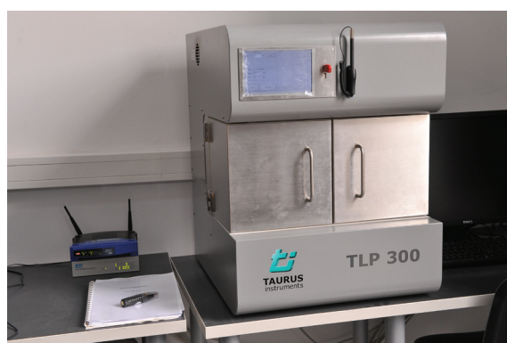
2. ábra: Hővezető képesség mérőműszer a Magasépítési Tanszéken (Philip János felvétele)
