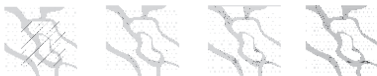
1. ábra: A porózus anyagok szerkezeti anizotrópiájának mérési módszerei: (a) egy adott irányban felvett egyeneseknek a csont és a velő közötti határfelületével való metszéspontjait számolva (MIL módszer), (b) adott pontokban megkeresve a leghosszabb olyan szakaszt, amely a csontanyagban belül fut (VO módszer), (c) különböző irányokban meghatározott szakaszok segítségével, (d) beillesztett ellipszoidok segítségével
