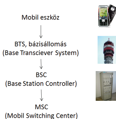
1. ábra: A GSM hálózat vázlatos felépítése
