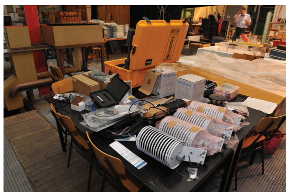
1. ábra: Duál hidrometerológiai állomás szerelés közben a Vízépítési és Vízgazdálkodási Tanszéken (Philip János felvétele)
